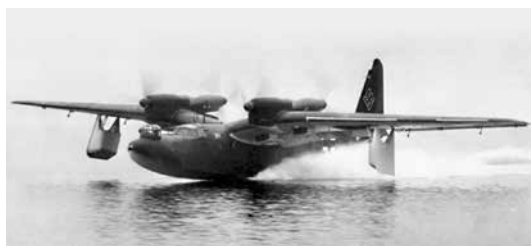
Dornier Do 26. Detta var en tekniskt mycket avancerad flygbåt som egentligen var avsedd att transportera post och/eller ett fåtal passagerare över Nordatlanten. För bästa bränsleekonomi hade den dieselmotorer, och vingflottörerna var infällbara. Bara sex stycken byggdes.
